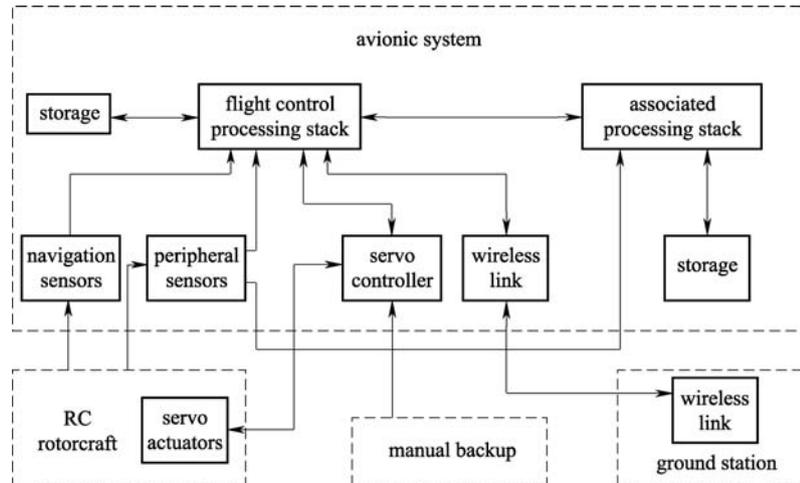
Fig. 2 System configuration of a mini rotorcraft UAV
