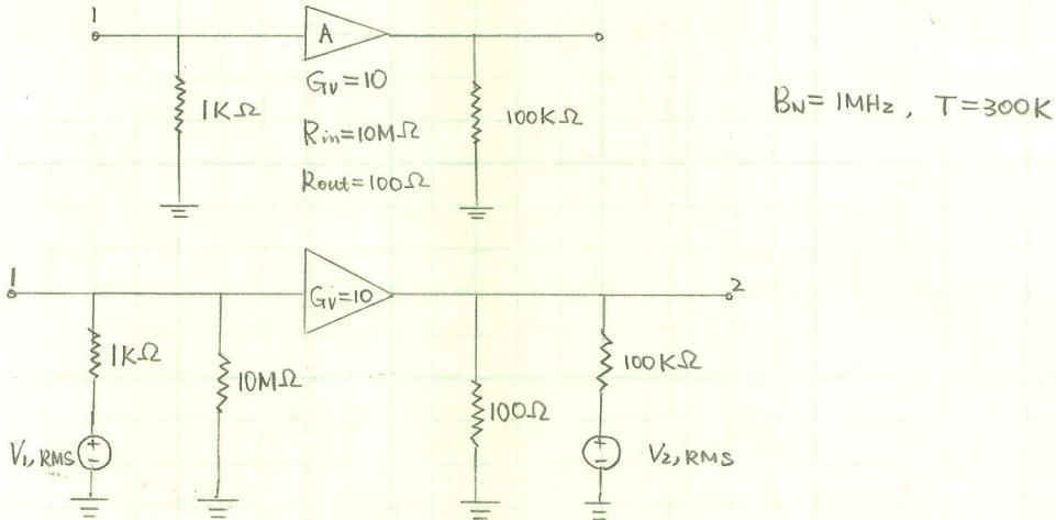
$V_{1,RMS} = \sqrt{4KTR_1 B_N} = \sqrt{4 \times 1.38 \times 10^{-23} \times 300 \times 10^3 \times 10^6} = 4.07 \times 10^{-6} \text{ V rms}$
