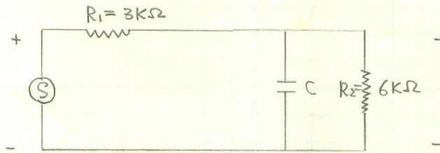
$$H(\omega) = \frac{jR_2}{R_1 R_2 C \omega - j(R_1 + R_2)}$$
